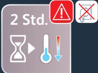
Das Gerät muss mindestens 2 Stunden von der Stromquelle getrennt und vollständig abgekühlt sein, bevor der Kollektor ausgespült werden kann.
